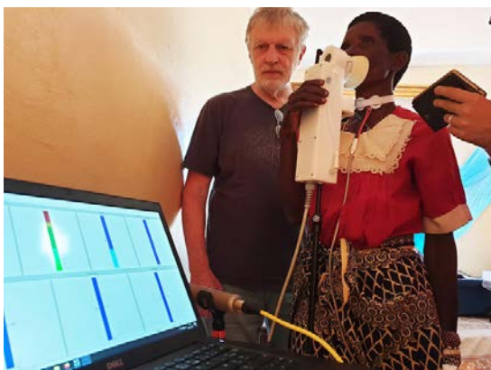
آیروفونومتری ۵ امکان اندازه‌گیری دقیق جریان هوا و فشار موجود در مجرای گفتار را فراهم می‌کند. (آلن غیو و گویشور زبان هوسایی - ۲۰۲۰)
